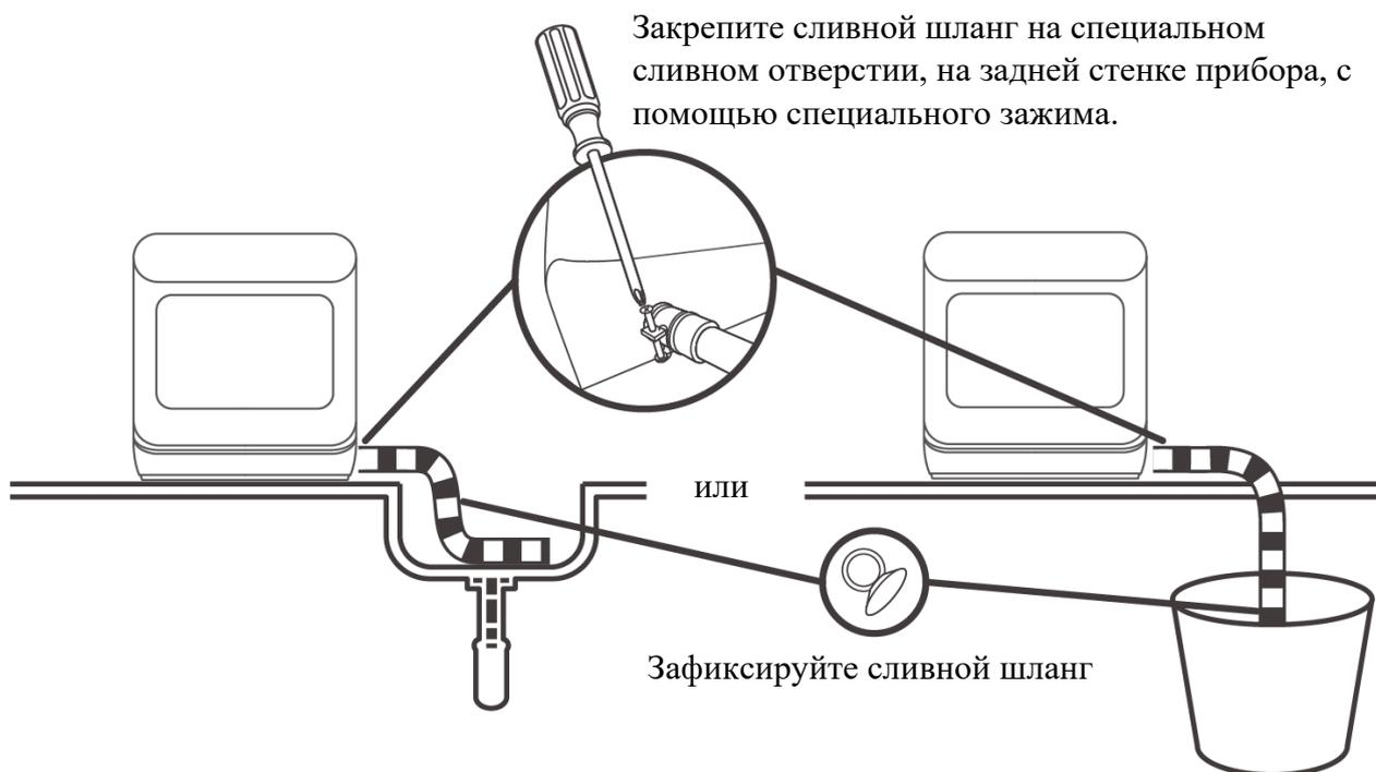
Закрепите сливной шланг на специальном сливном отверстии, на задней стенке прибора, с помощью специального зажима.
